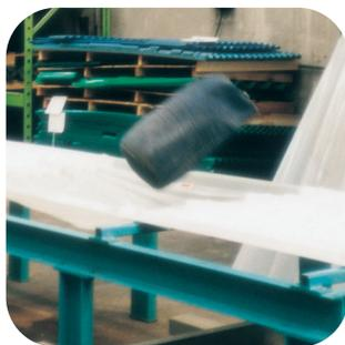
\*Foto: Fallversuch zum Nachweis der Beständigkeit der Platten aus der HR-Produktreihe gegenüber einem Schlag mit einer Energie von 1200 J, die beim Herabfallen eines 50 kg schweren Sacks aus einer Höhe von 2,40 m entwickelt wird...
